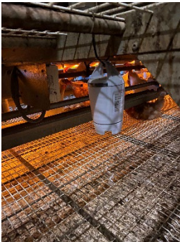
Ammoniämätning med X-node
